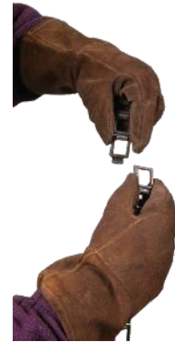
Schalmen kunnen eenvoudig aangebracht en verwijderd worden voor de verschillende pijp-Ø.
